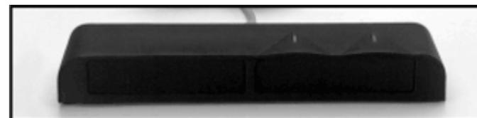
При первом включении светодиоды загораются не более, чем на 20 сек. В течение этого времени избегайте детектирования для правильной настройки прибора. Затем светодиоды загораются при каждом детектировании.
