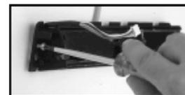
Закрепите корпус устройства прилагаемыми винтами и подключите разъем электрокабеля.
