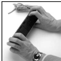
Для разборки отожмите пластиковые защелки и снимите крышку корпуса.
