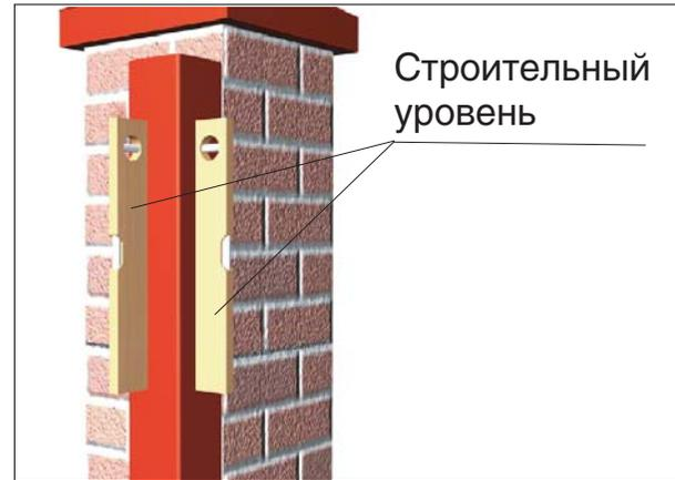
2. Строительным уровнем проверьте вертикальность расположения 2-х перпендикулярных плоскостей каждого столба. Запрещается использовать столбы проема в качестве базы для вертикальности установки навесных столбов №6.
