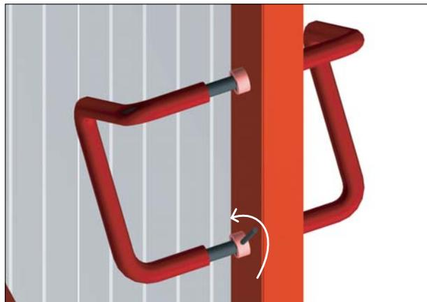
8. С помощью воротка попеременно вкрутите оба винта по 3-5 мм за прием. Так как винты и ручки имеют правую и левую резьбы, то при вкручивании винта в первую ручку происходит одновременное вкручивание другого конца винта во вторую ручку.
