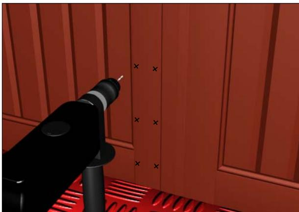
2. Просверлите 6 отверстий  $\varnothing 4$ .
