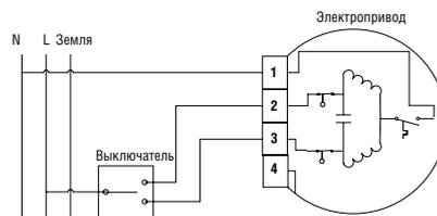
Рис. 3. Подключение выключателя.
