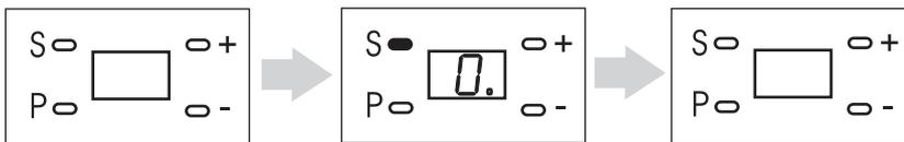
Для удаления пультов из памяти приемника, нажмите и удерживайте в течение 8 сек. нажатой кнопку S, пока не погаснет индикатор (точка) внизу дисплея, при этом раздастся короткий звуковой сигнал.
