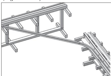
Расположите на стапеле изгиб горизонтальной направляющей на С-профиле и вертикальную направляющую на угловой стойке
