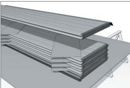
Установите верхнее резиновое уплотнение на верхний алюминиевый профиль в паз, расположенный ближе к наружной стороне полотна ворот так, чтобы по краям оно выступало на 15 мм.
