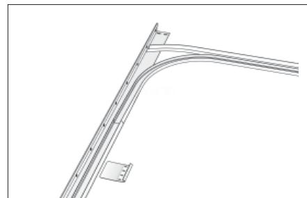
Установите соединительную пластину в месте стыка изгиба горизонтальной направляющей и вертикальной направляющей.
