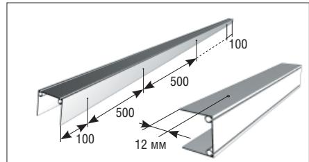
Отметьте и просверлите сквозные отверстия Ø4,2 мм в верхнем и нижнем алюминиевых профилях. Необходимо производить сверление на сверлильном станке (участок №8).
