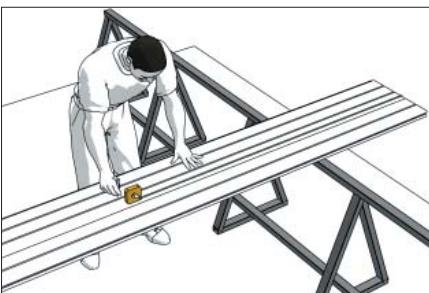
Отмерьте на заготовке сэндвич-панели длину панели, указанную в карте, уменьшенную на 5 мм (для установки боковых крышек).
