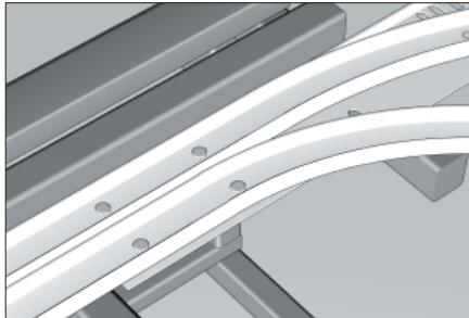
Скрепите указанные детали при помощи болтов с гайками (арт. 14010, 14013).
