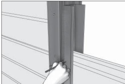
Произведите разметку боковых Ц и П-профилей по стыку петель. Отрежьте их и закрепите профиль на нижнем сегменте с помощью заклепок.
