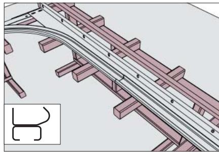
Расположите изгиб горизонтальной направляющей на С-профиле и вертикальную направляющую на угловой стойке (участок №15).
