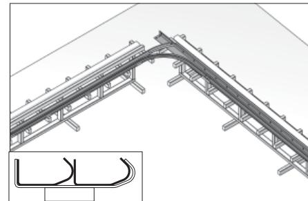
Расположите изгибы горизонтальных направляющих и вертикальную направляющую на угловой стойке (участок №15). Установите кронштейн соединительный для сдвоенных направляющих.
