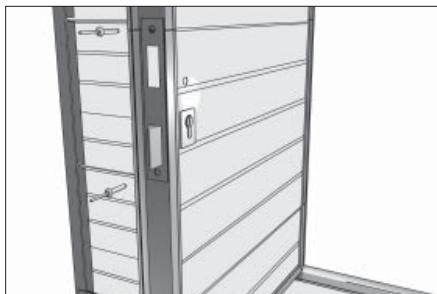
Вставте замок и личинку в сегмент калитки. И закрепите замок с торца с помощью заклепок.
