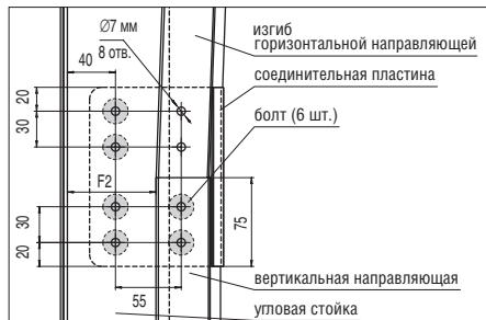
Просверлите совместные отверстия  $\varnothing 7$  мм (8 отв.) в угловой стойке и соединительной пластине. Установите соединительную пластину на вертикальную направляющую и закрепите шестью болтами с гайками (арт. 14010, 14013).
