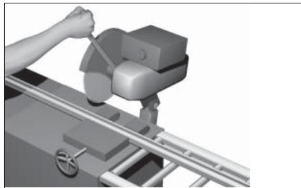
Пила циркулярная поворотная для резки алюминиевых профилей.
