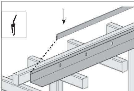
Отмерьте и отрежьте от бокового уплотнителя длину, указанную в карте «Цех». Установите боковой уплотнитель на угловую стойку, совмещая низ угловой стойки и низ уплотнителя (участок №15).
