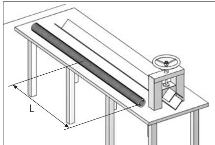
От длинномерной заготовки отмерьте длину пружины, указанную в карте «Цех» (участок №10).
