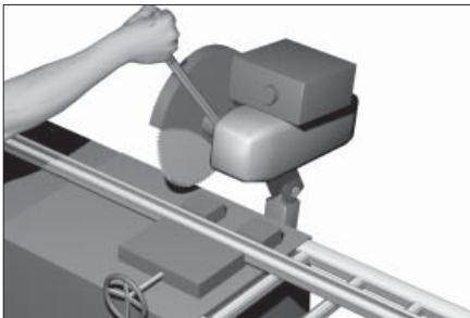
От длинномерной заготовки отрежьте необходимую длину вала (участок №6).
