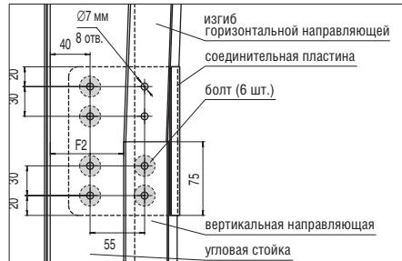
Просверлите совместные отверстия  $\varnothing 7$  мм (8 отв.) в угловой стойке и соединительной пластине. Установите соединительную пластину на вертикальную направляющую и закрепите шестью болтами с гайками (арт. 14010, 14013).
