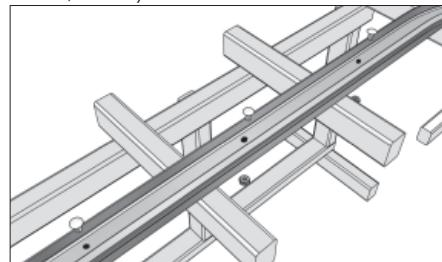
Просверлите совместные отверстия  $\varnothing 7$  мм в намеченных точках. Соедините С-профиль с изгибом горизонтальной направляющей при помощи болтов с гайками (арт. 14010, 14013).
