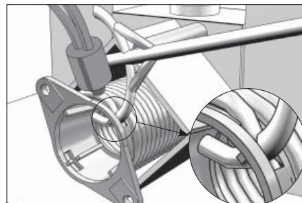
Концы пружин D95 и D152 нагрейте газовым резаком равномерно до красного свечения и загните вовнутрь окончания при помощи приспособления. Загнутый конец не должен мешать подшипнику боковой опоры.
