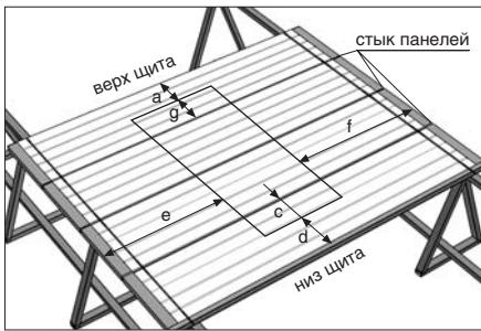
б) Верхняя и нижняя линии проема калитки (размеры а, с, г) не должны проходить ближе, чем на 100 мм от линии стыка панелей щита;
