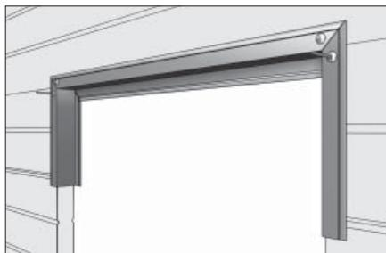
Закрепите верхний горизонтальный Ц-профиль с помощью заклепок, а боковые Ц-профили наживите в углах с помощью заклепок.
