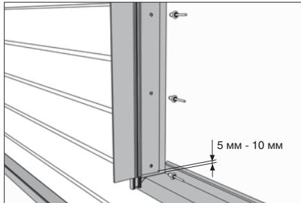
Установка нижней петли (с учетом нижнего зазора).
