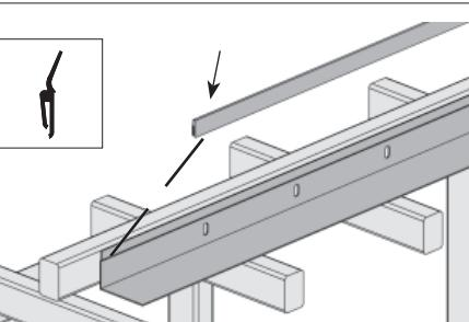
Отмерьте и отрежте от бокового уплотнителя длину, указанную в карте «Цех». Установите боковой уплотнитель на угловую стойку, совместив низ угловой стойки и низ уплотнителя (участок №15).
