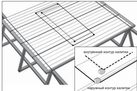
Просверлите сквозные отверстия Ø8-12 мм по углам контура для введения полотна лобзика.
