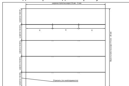
Петли распределяются равномерно по длине всей панели. По количеству петель, указанных в карте «Цех», отметьте и просверлите в верхних частях панелей (на нижней и средних панелях) отверстия Ø4 мм на глубину до 10 мм.
