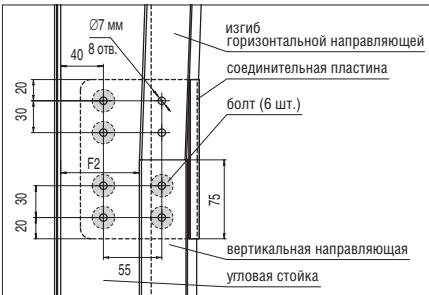
Просверлите совместные отверстия  $\varnothing 7$  мм (8 отв.) в угловой стойке и соединительной пластине. Установите соединительную пластину на вертикальную направляющую и закрепите шестью болтами с гайками (арт. 14010, 14013).
