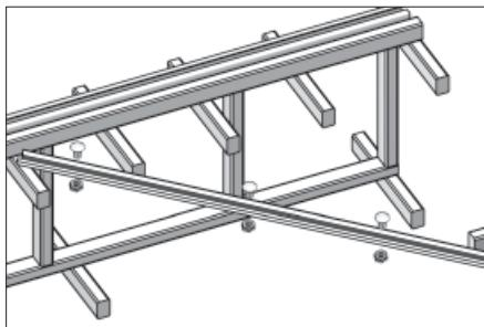
Просверлите совместные отверстия  $\varnothing 7$  мм в намеченных точках. Соедините С-профиль с изгибом горизонтальной направляющей при помощи болтов с гайками (арт. 14010, 14013).
