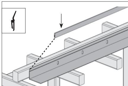
Отмерьте и отрежьте от бокового уплотнителя длину, указанную в карте «Цех». Установите боковой уплотнитель на угловую стойку, совместив низ угловой стойки и низ уплотнителя (участок №15).
