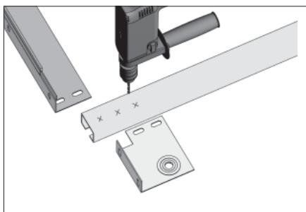
Просверлите отверстия Ø12 мм в С-профиле.
