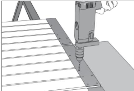
Просверлите отверстия Ø4,2 мм глубиной до 10 мм в панелях для крепления боковых крышек и алюминиевых профилей.
