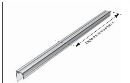
Отмерьте и отрежьте от длинномерного алюминиевого профиля необходимые длины заготовок, указанные в карте «Цех», верхнего и нижнего алюминиевых профилей. Необходимо производить нарезку на станке.
