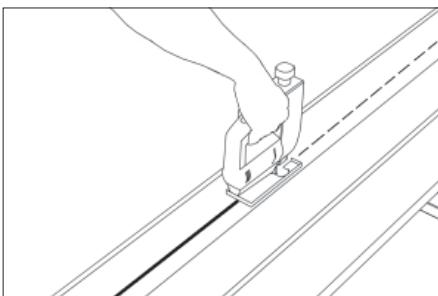
При необходимости производится обрез верхней и/или нижней панелей с тем чтобы высота Н полотна ворот, указанная в карте «Цех», уменьшилась на 20 мм – для установки верхнего и нижнего алюминиевых профилей.
