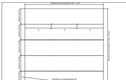
Петли распределяются равномерно по длине всей панели. По количеству петель, указанных в карте «Цех», отметьте и просверлите в верхних частях панелей (на нижней и средних панелях) отверстия Ø4 мм на глубину до 10 мм.
