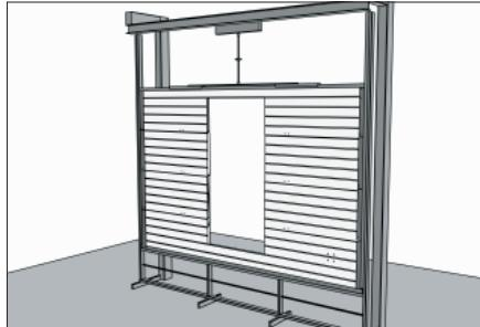
Установите полотно ворот на «стапель для установки калитки». На стапель устанавливаются те панели, в которых вырезан проем калитки. Щит ворот выравнивается по торцевым крышкам и поджимается верхним прижимом (участок 14).
