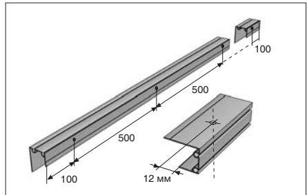
Отметьте и просверлите сквозные отверстия Ø4,2 мм в верхнем и нижнем алюминиевых профилях. Необходимо производить сверление на сверлильном станке (участок №8).
