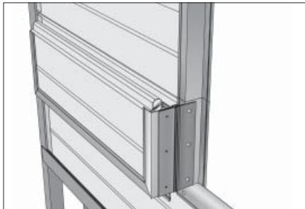
Снимите все сегменты калитки кроме нижнего. Приставте нижний сегмент калитки к раскрытой петле и закрепите их с помощью заклепок, соблюдая боковой зазор 2 мм (см. рис. 1.24).
