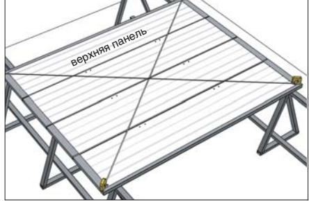
Проверьте диагонали полотна ворот. Диагонали должны быть равны. Проверьте ширину и высоту полотна ворот.
