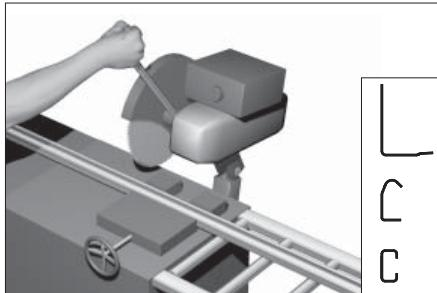
Отмерьте и отрежте от длинномерных заготовок: угловой стойки, С-профиля, вертикальной направляющей и изгиба горизонтальной направляющей длину, указанную в карте «Цех». Обработайте места реза, сняв заусенцы (участок №6).
