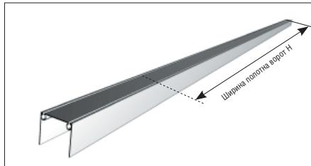
Отмерьте и отрежьте от длинномерного алюминиевого профиля необходимые длины заготовок, указанные в карте «Цех», верхнего и нижнего алюминиевых профилей. Необходимо производить нарезку на станке
