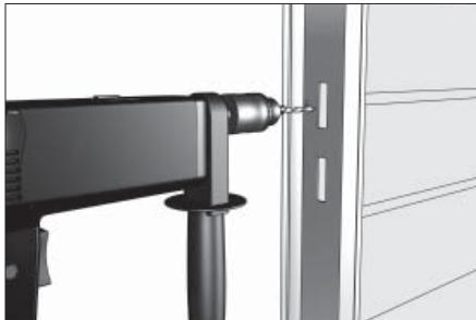
Просверлите отверстия в торце проема калитки для защелки и ригеля замка.
