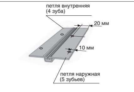
Просверлите отверстия Ø4 мм в заготовленных петлях.
