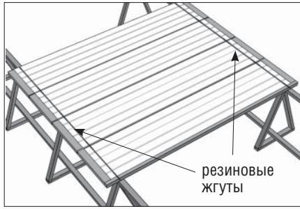
Соберите щит ворот (см. раздел сборки щита ворот, рис.-1.1-1.22) на стапеле внутренней поверхностью вниз. Стяните щит по краям резиновыми жгутами для достижения минимального зазора между панелями (участок 13).
