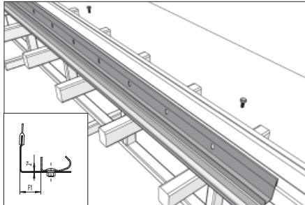
Просверлите совместные отверстия  $\varnothing 7$  мм в намеченных точках. Соедините угловую стойку с вертикальной направляющей при помощи болтов с гайками (арт. 14013, 14010).
