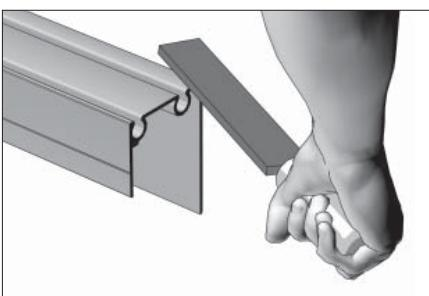
Обработайте места реза, сняв заусенцы напильником.
