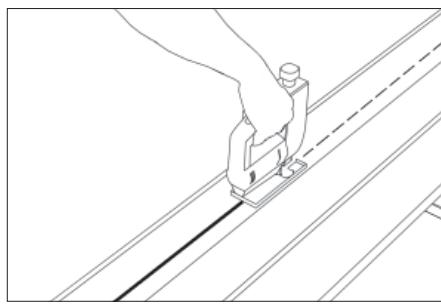
При необходимости производится обрез верхней и/или нижней панелей с тем чтобы высота Н полотна ворот, указанная в карте «Цех», уменьшилась на 20 мм – для установки верхнего и нижнего алюминиевых профилей.
