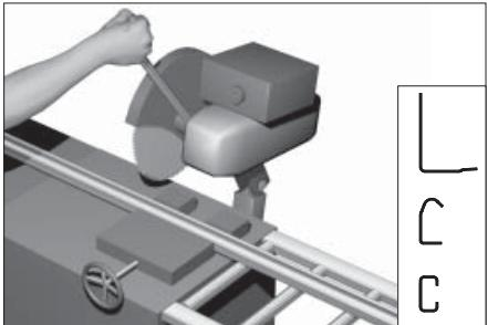
Отмерьте и отрежте от длинномерных заготовок: угловой стойки, С-профиля, вертикальной направляющей и изгиба горизонтальной направляющей длины, указанные в карте «Цех». Обработайте места реза, сняв заусенцы (участок №6).
