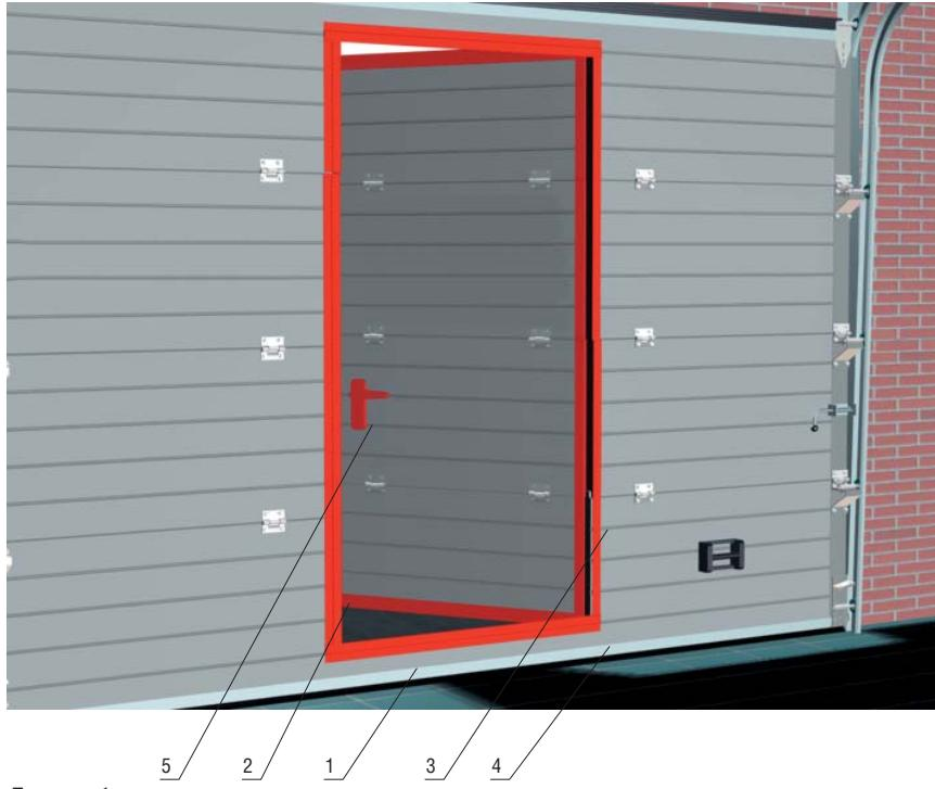
Для удобства изготовления калитки разметка и резка проема производится при размещении щита ворот в горизонтальном положении, предварительно стягивая панели резиновым жгутом. Сборка калитки происходит при закреплении щита ворот в вертикальном положении или в установленном щите ворот в самом проеме.
