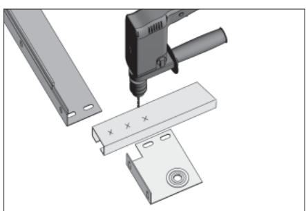
Просверлите отверстия Ø12 мм в С-профиле. Обработайте места сверления, сняв заусенцы (участок №6).
