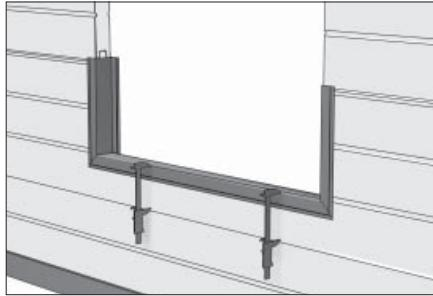
Установите на низ проема П-профиль и выровняйте его по горизонтали (ориентируясь по полосам панелей ворот). По краям установите заготовки Ц-профиля.
