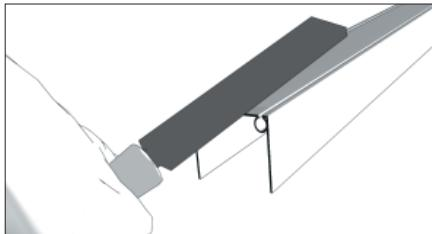
Обработайте места реза, сняв заусенцы напильником.
