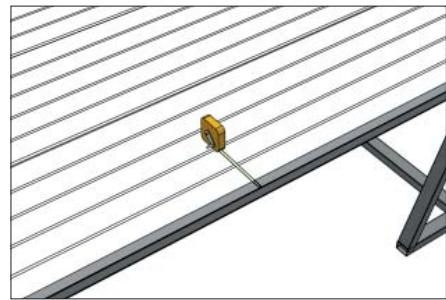
Произведите с помощью карандаша, рулетки и линейки разметку проема калитки с учетом следующих условий: а) Расстояние от нижнего края щита до нижней части проема калитки не должно быть меньше 140 мм;
