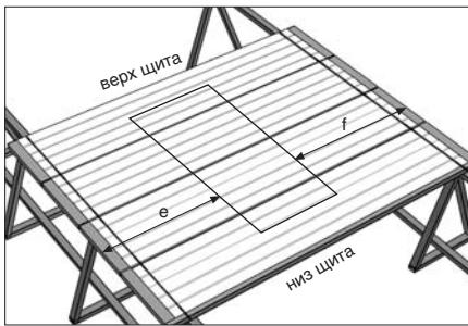
в) Для сохранения параметров калитки при эксплуатации желательно проем калитки не вырезать ближе, чем на 500 мм от бокового края щита (размеры е, ф).
