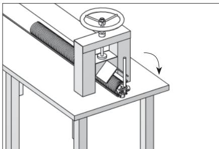
Вкрутите поочередно с двух концов окончания с помощью прута Ø12 мм.
