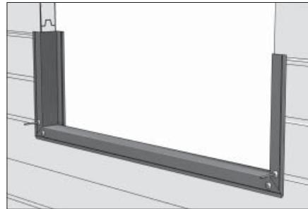
Закрепите нижний П-профиль с помощью заклепок с наружной стороны щита ворот. А боковые Ц-профили наживите с помощью заклепок.
