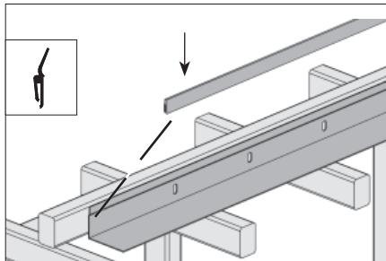
Отмерьте и отрежте от бокового уплотнителя длину, указанную в карте «Цех». Установите боковой уплотнитель на угловую стойку, совмещая низ угловой стойки и низ уплотнителя (участок №15).
