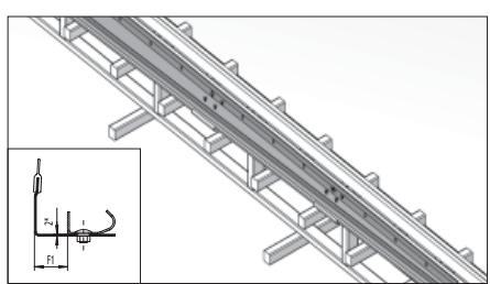
Просверлите совместные отверстия Ø7 мм в намеченных точках. Соедините угловую стойку, соединительные пластины с вертикальной направляющей при помощи болтов с гайками (арт. 14010, 14013).
