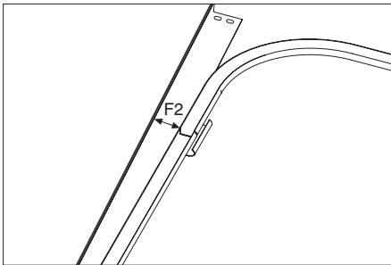
Установите соединительную пластину в месте стыка изгиба горизонтальной направляющей и вертикальной направляющей.
