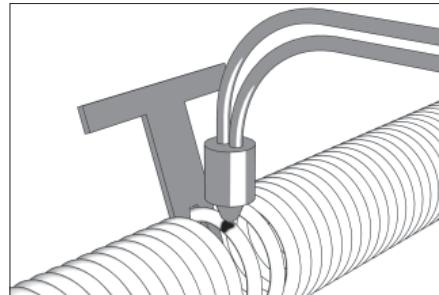
Газовым резаком произведите обрезку пружины.
