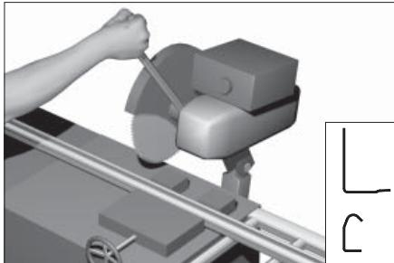
Отмерьте и отрежте от длинномерных заготовок: угловой стойки, вертикальной направляющей и изгибов горизонтальной направляющей, длины, указанные в карте «Цех». Обработайте места реза, сняв заусенцы (участок №6).
