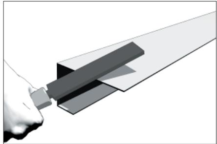
Обработайте места реза, сняв заусенцы напильником.
