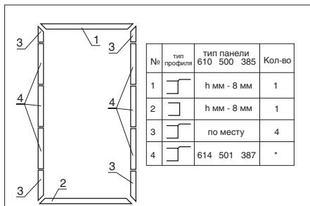
Из длинномерных заготовок алюминиевого профиля изготавливаются заготовки окантовки проема.
