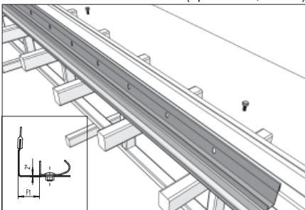
Просверлите совместные отверстия  $\varnothing 7$  мм в намеченных точках. Соедините угловую стойку с вертикальной направляющей при помощи болтов с гайками (арт. 14010, 14013).
