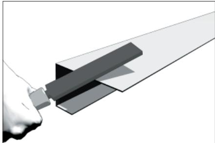
Обработайте места реза, сняв заусенцы напильником.
