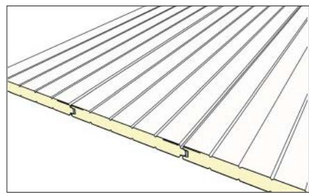
Уложите панели на стапеле (участок №12) плотно друг к другу внутренней стороной вверх. Выравните панели по ширине.
