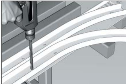
Установите кронштейн крепления шкива и просверлите отверстия Ø7 мм для его крепления к горизонтальным направляющим.
