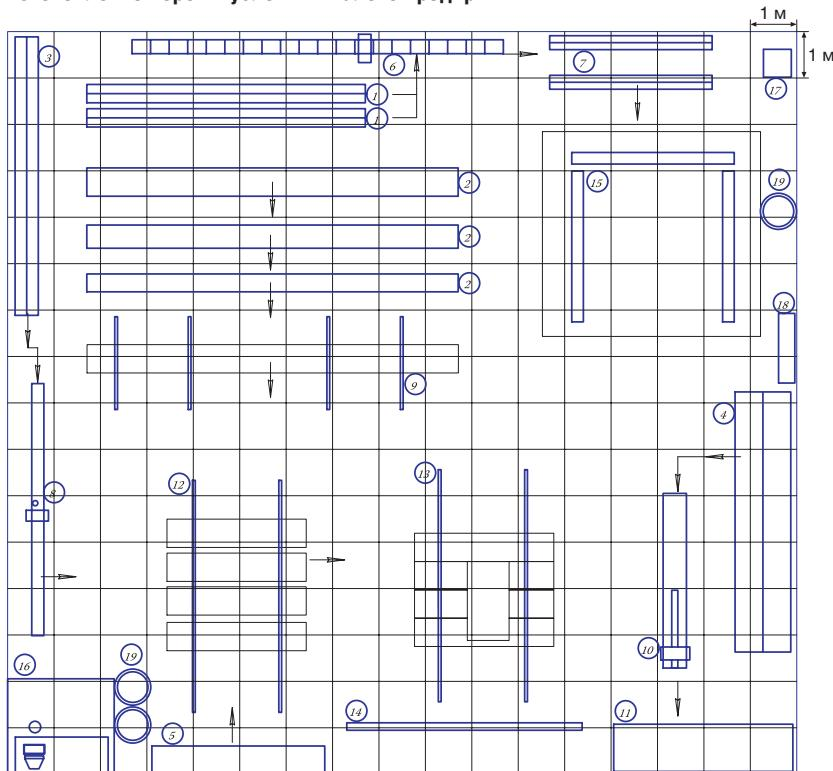
Схема участка изготовления и сборки секционных ворот.
