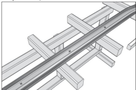
Наметьте места крепления изгиба горизонтальной направляющей к С-профилю и крепления вертикальной направляющей к угловой стойке.
