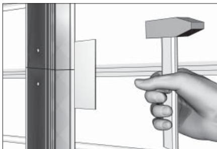
Закройте калитку. Выровняйте по стыкам все профили и закрепите их с помощью заклепок с внутренней и наружной стороны. Закрепите с наружной стороны проема профили проема калитки и профили самой калитки.
