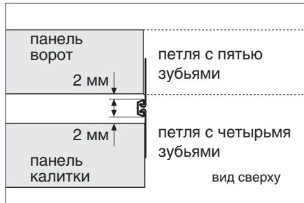
Установите нижнюю петлю с учетом бокового зазора 2 мм. К панели ворот закрепите петлю с пятью зубьями, к панели калитки – петлю с четырьмя зубьями.
