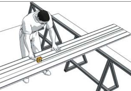
Отмерьте на заготовке сэндвич-панели длину панели, указанную в карте, уменьшенную на 5 мм (для установки боковых крышек).
