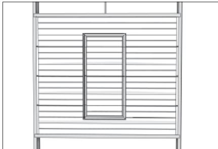
Выровняйте по линейке все профили на полотне калитки и закрепите алюминиевые профили на нижнем и верхнем сегменте с помощью заклепок.
