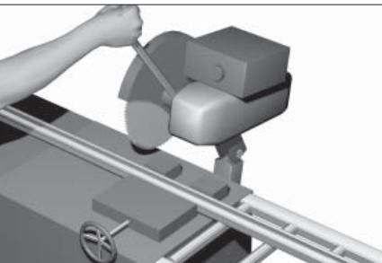
Нарезка алюминиевого профиля с помощью поворотной электропилы с диском для резки алюминия (участок 8).
