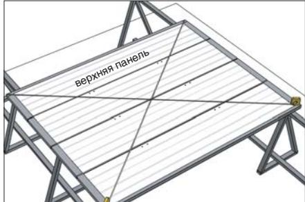
Проверьте диагонали полотна ворот. Диагонали должны быть равны. Проверьте ширину и высоту полотна ворот.
