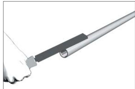
Обработайте места среза, сняв заусенцы напильником.
