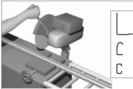
Отмерьте и отрежьте от длинномерных заготовок: угловой стойки, С-профиля, вертикальной направляющей и изгиба горизонтальной направляющей длины, указанные в карте «Цех».
