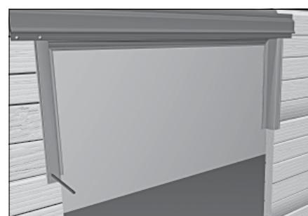
Установите верхние боковые Ц-профили. По месту отмерьте их длину, ориентируясь по середине стыков панелей, и отрежьте с помощью ножовки по металлу.
