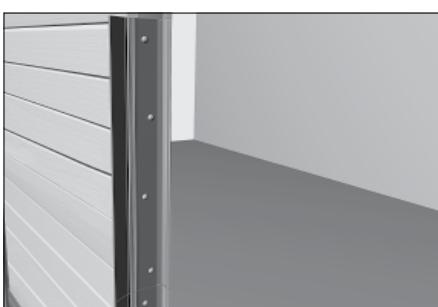
Нижняя и верхняя петли устанавливаются с учетом зазора 10 мм. Остальные петли установите плотную друг к другу, стык встык.
