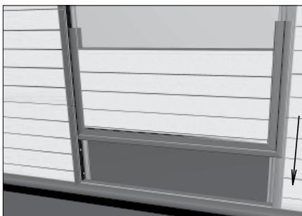
Установите на нижний сегмент калитки горизонтальный и боковой Ц-профиль и П-профиль (последний устанавливается с той стороны, где крепится петля). Установите нижний сегмент в проем калитки, обеспечивая зазор 10 мм между сегментом калитки и низом проема.
