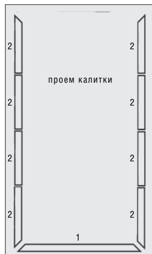
Из длинномерных заготовок алюминиевого профиля изготавливаются заготовки окантовки проема и полотна калитки. Длина боковых заготовок должна быть больше высоты панели на 20 мм, а длина верхних и нижних заготовок быть больше ширины проема калитки на 20 мм.
