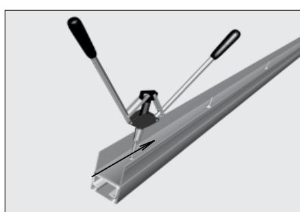
Установите стальной С-профиль во внутреннюю камеру нижнего несущего профиля по всей его длине. Закрепите С-профиль заклепками с шагом не более 500 мм.
