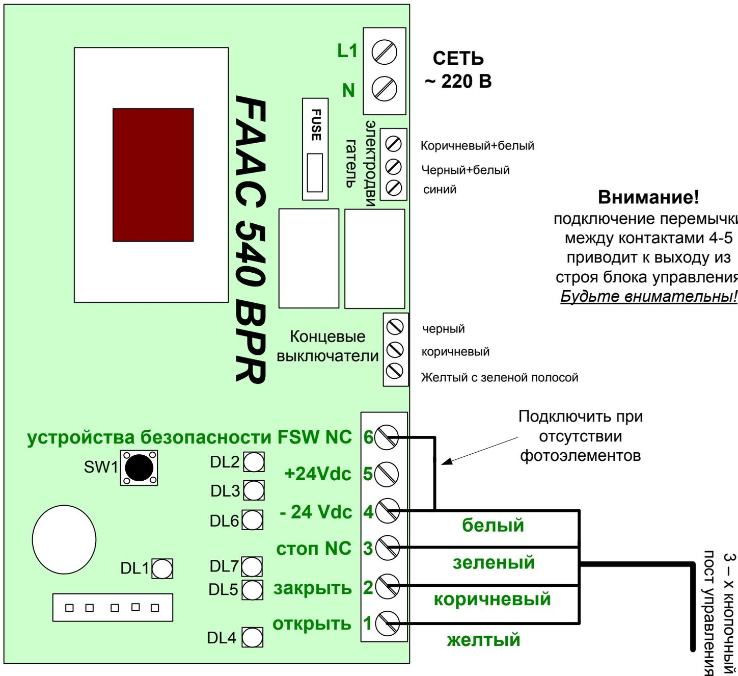
Перед программированием проверьте состояние индикаторов DL2 – DL7
